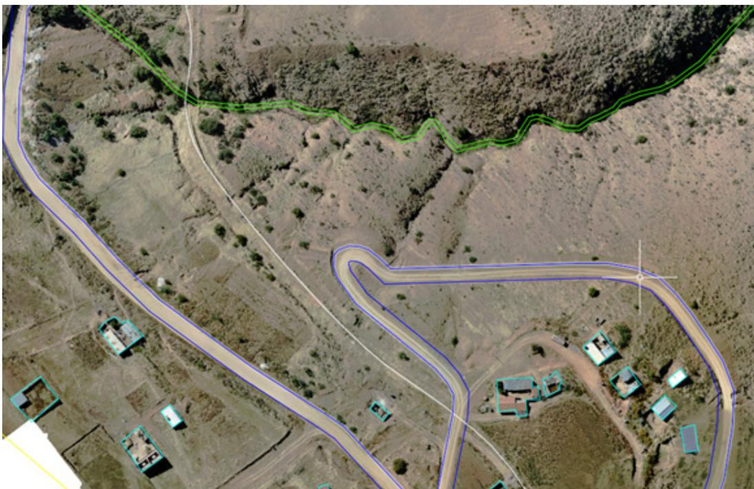
**Figura 5.** Vectorización en AutoCAD a partir del ortomosaico.
