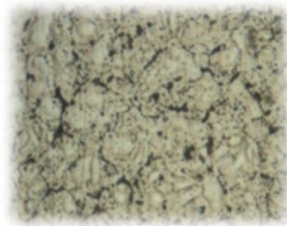
Figura 17. Fase y estructura del material de aporte (Cordón). Aumento de 500 X. Ataque con Keller.
