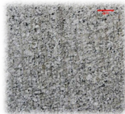
Figura 18. Fase y estructura del material base. Aumento de 100 X. Ataque con Keller.
