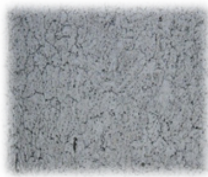
Figura 16. Fase y estructura del material de aporte (Cordón). Aumento de 100 X. Ataque con Keller.
