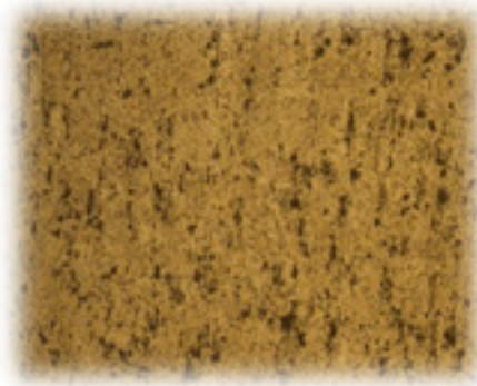
Figura 24. Fase y estructura del material base. Aumento de 100 X. Ataque con Keller.
