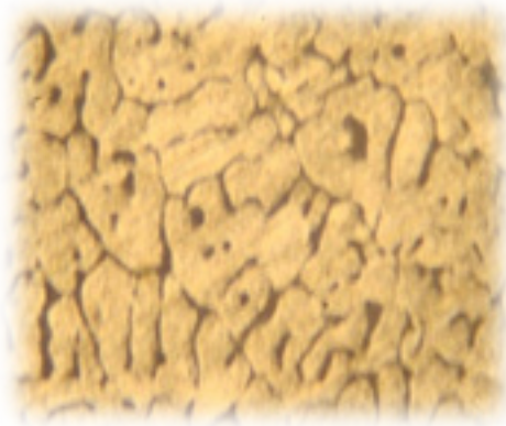
Figura 11. Fase y estructura del material de aporte (Cordón). Aumento de 500 X. Ataque con Keller.
